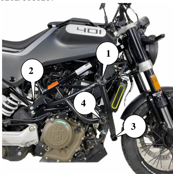
Рис 1 Установленная клетка вид справа
