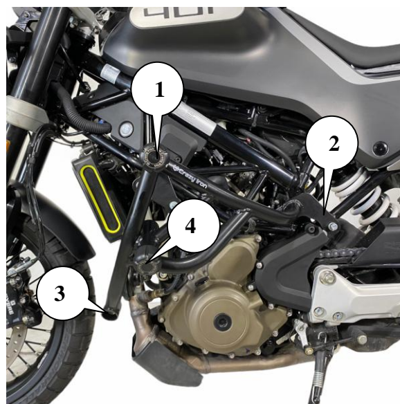
Рис 2 Установленная клетка вид слева
