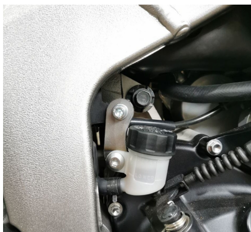
Рис 3 Вид на точку №2 правой стороны (перенос бачка заднего тормоза)
