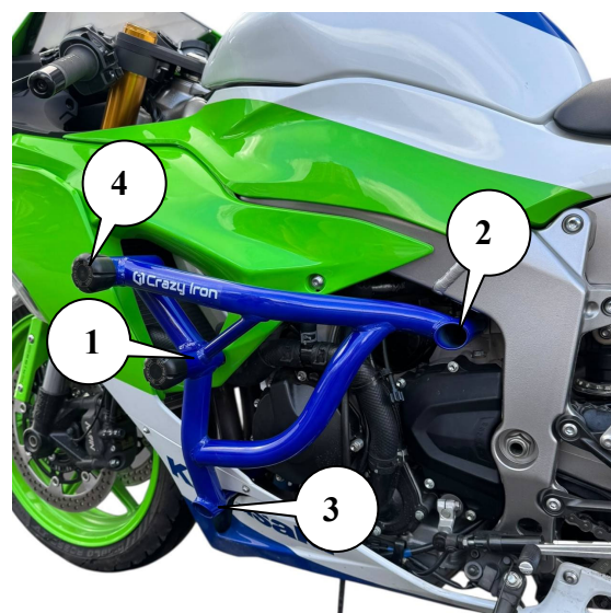
Рис 2 Установленная клетка вид слева
