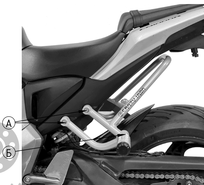
Рис 2 Установленный садкейдж, вид слева.
