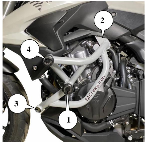
Рис.2. Установленная клетка вид слева
