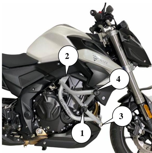
Рис.1. Установленная клетка вид справа
