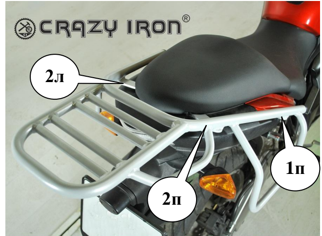
Рис 2 Вид слева на установленное крепление заднего кофра и боковых сумок
