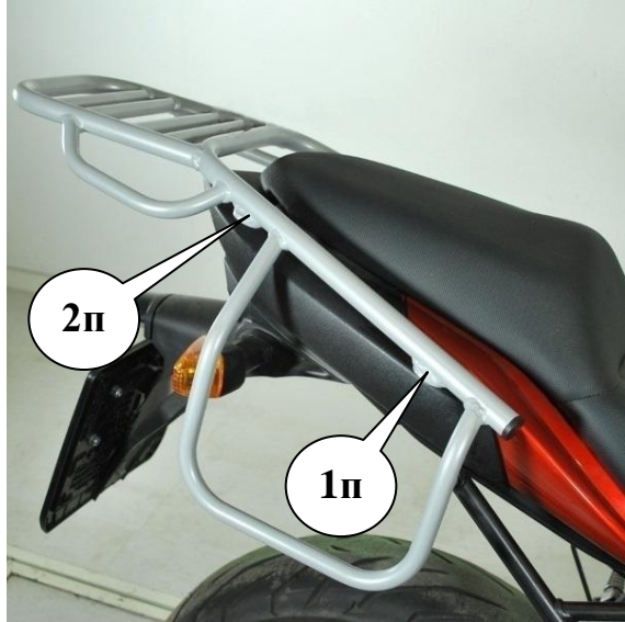
Рис 1 Вид сверху на установленное крепление заднего кофра и боковых сумок
