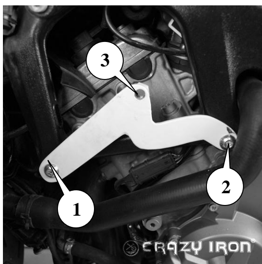
Рис 1 Вид на установленный кронштейн левой стороны
