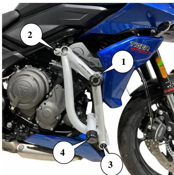
Рис.1. Установленная клетка вид справа
