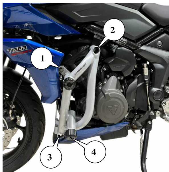
Рис.2. Установленная клетка вид слева
