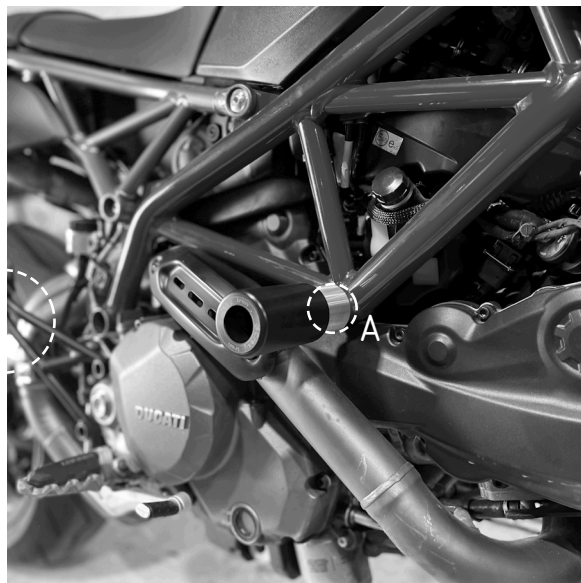
Рис 1 Используемая точка крепления двигателя к раме, правой стороны.
