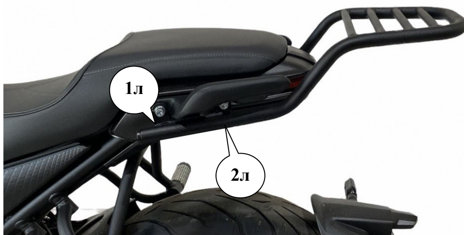
Рис 2 Вид слева на установленное крепление заднего кофра
