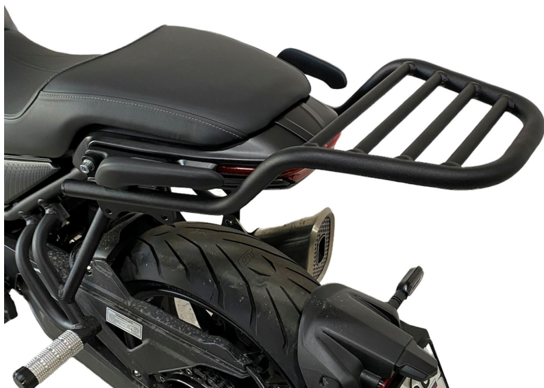
Рис 1 Общий вид сзади на установленное крепление заднего кофра
