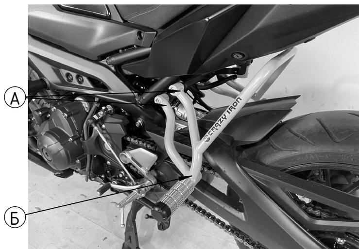
Рис 1 Установленный садкейдж, вид слева.
