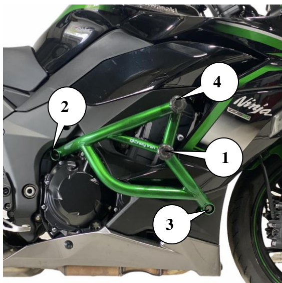
Рис.1. Установленная клетка вид справа
