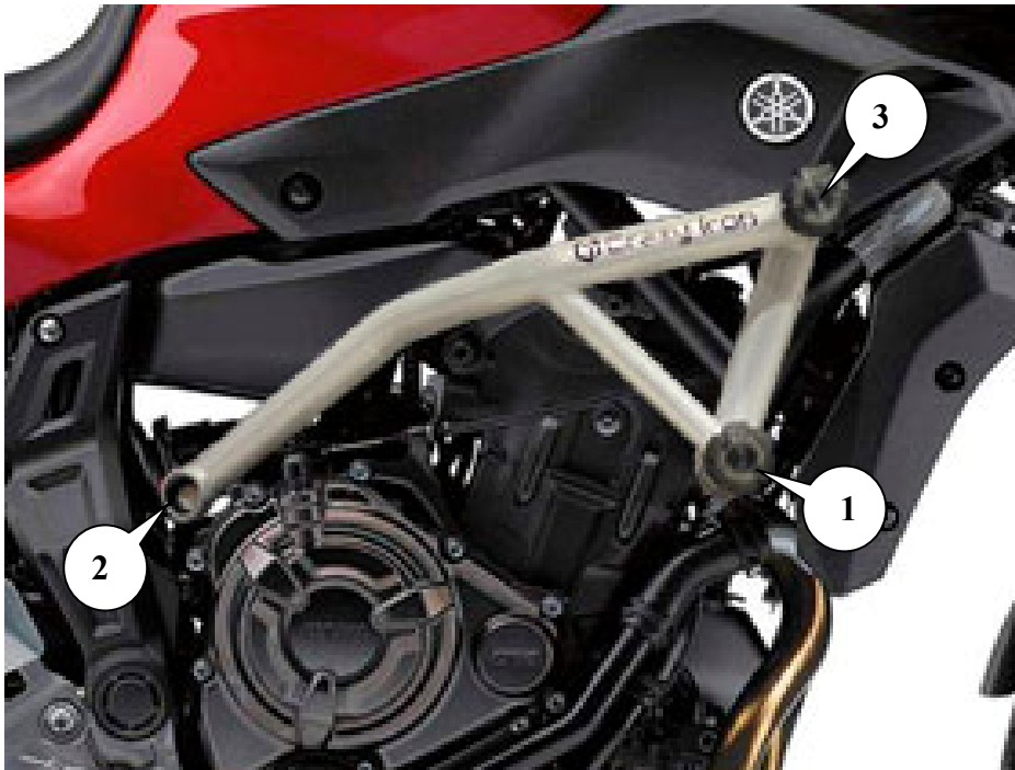
Рис. 1 Установленная защита вид справа.
