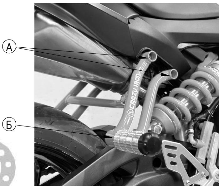
Устанавливается на посадочные места заводских штатных подножек. Для крепления садкейжа используется оригинальный крепеж подножек.
