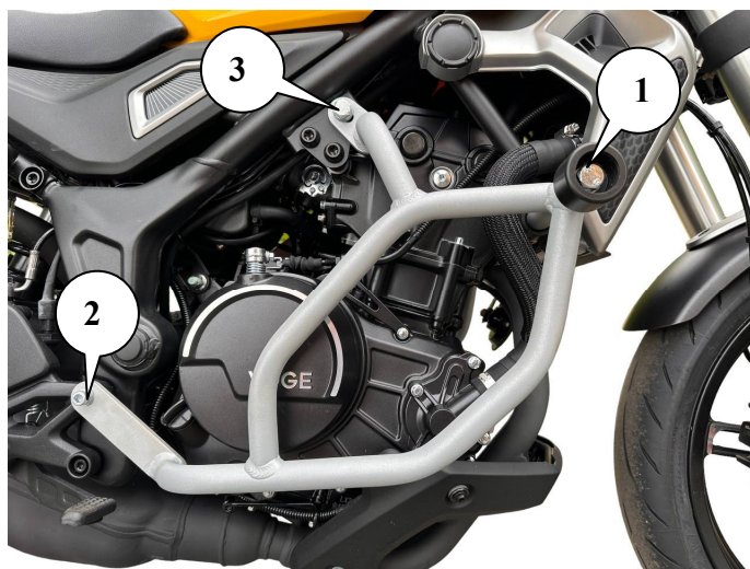
Рис.1. Установленная клетка вид справа
