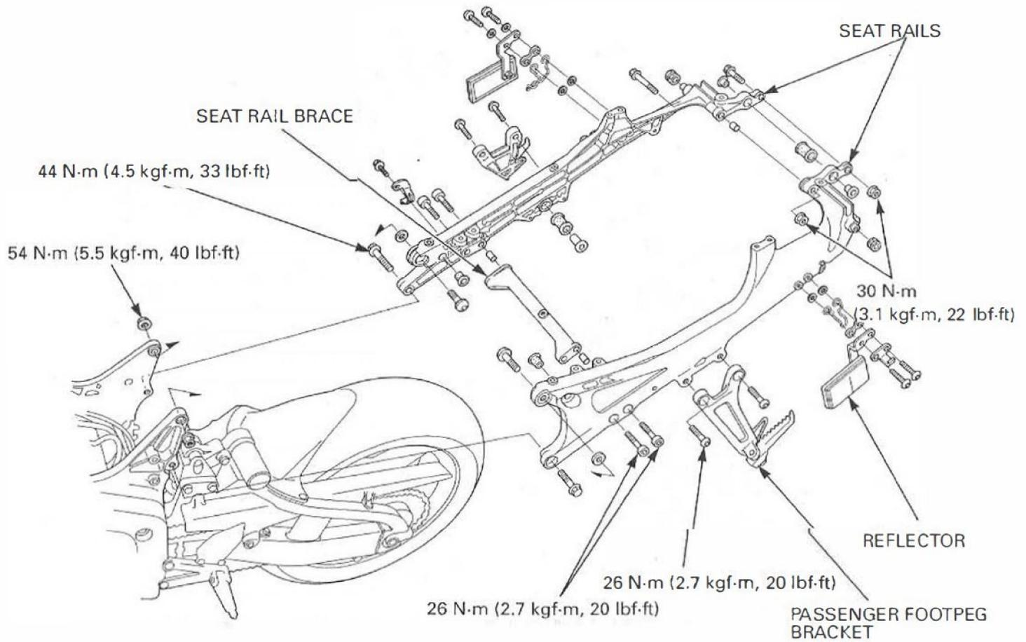
Рис 3 Схема пункт 3-19 из Honda CBR600RR 2006 Service Manual.
