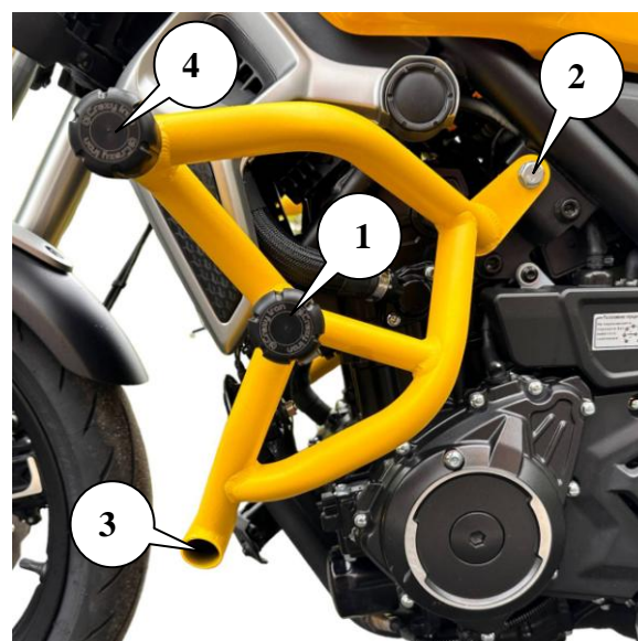
Рис.2. Установленная клетка вид слева
