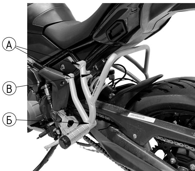
Рис 2 Установленный садкейдж, вид слева.
