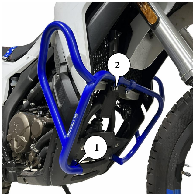
Рис.1 Установленные дуги вид справа
