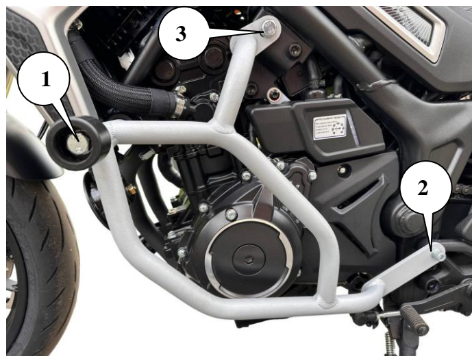
Рис.2. Установленная клетка вид слева
