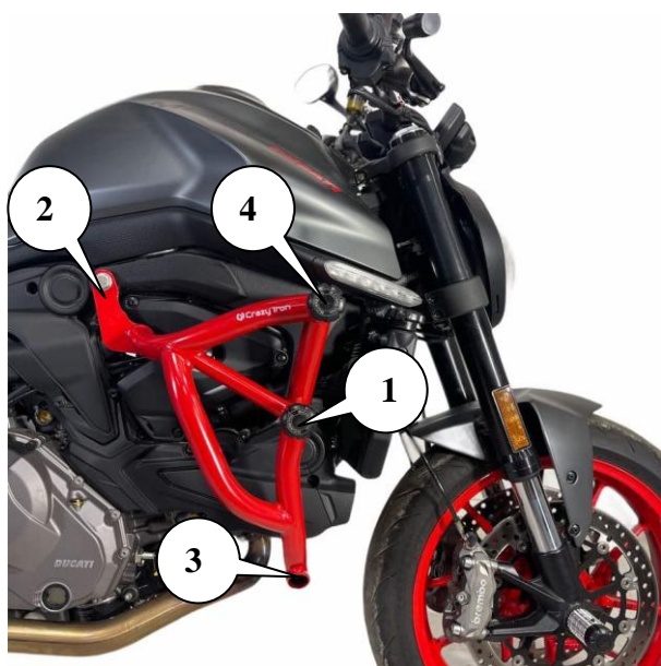
Рис.1. Установленная клетка вид справа
