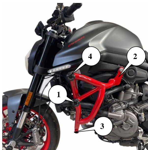
Рис.2. Установленная клетка вид слева
