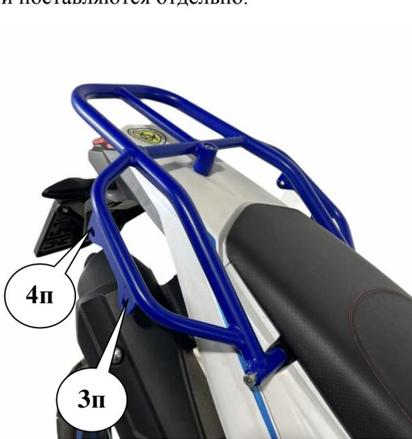
Рис 1 Вид справа на установленное крепление заднего кофра
