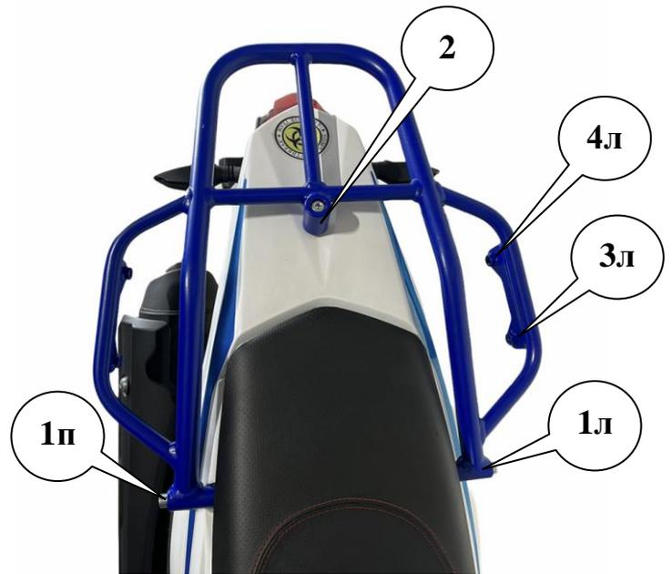
Рис 2 Общий вид сверху на установленное крепление заднего кофра
