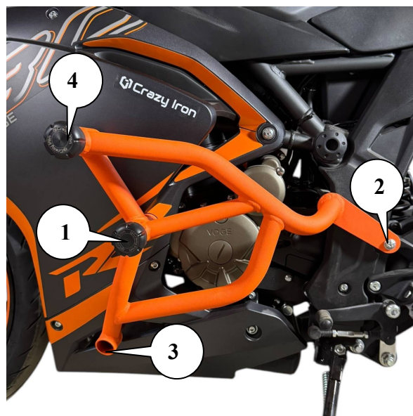
Рис 2 Установленная клетка вид слева
