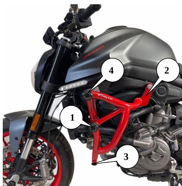
Рис.2. Установленная клетка вид слева
