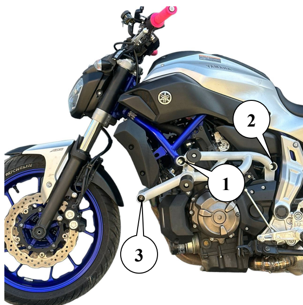
Рис.1. Установленная клетка вид слева
