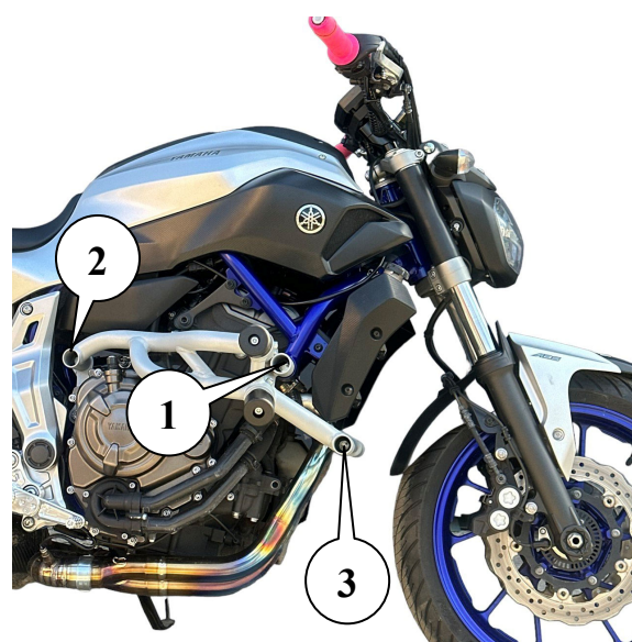
Рис.2. Установленная клетка вид справа
