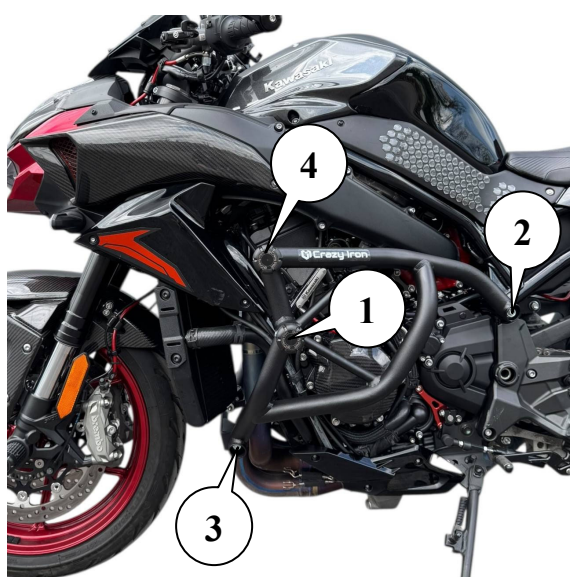
Рис.1. Установленная клетка вид слева
