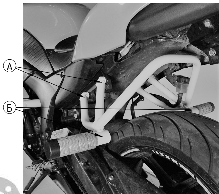
Рис 2 Установленный садкейдж, вид слева.
