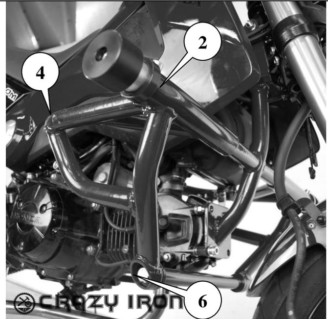
4 Используя резьбовую штангу d.16 L=255мм и комплект крепежа: 2 болта M10x1.25x30, соедините половинки клетки в точках №5 и №6.
