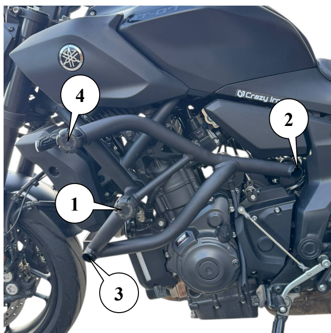
Рис.1. Установленная клетка вид слева
