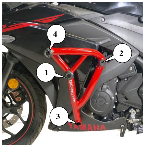
Рис.2. Установленная клетка вид слева
