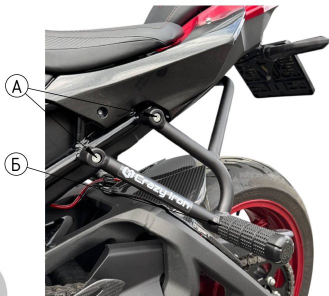
Рис 2 Установленный садкейдж, вид слева.
