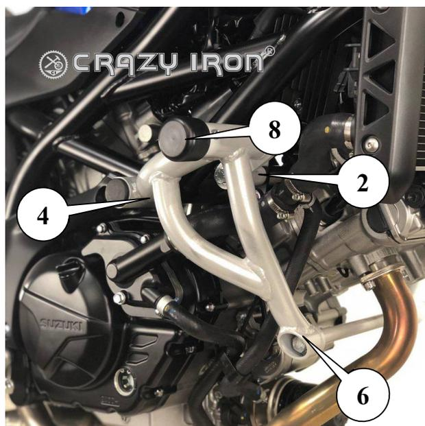
1. Болт M10x1,25x80 + шайба + гровер+пластина рис. 1 через проставочную втулку 22x10x45
