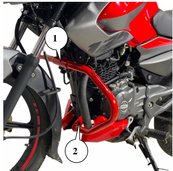
Рис.2. Установленная защита вид слева
