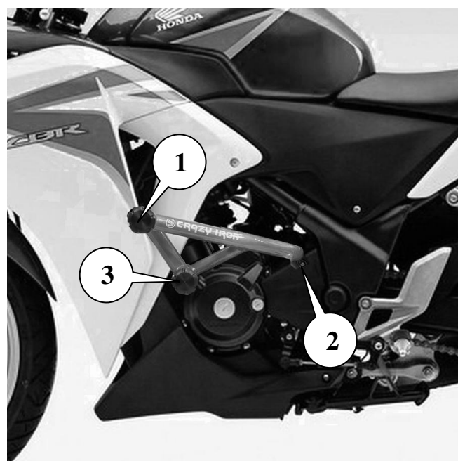
Рис.2. Установленная клетка вид слева
