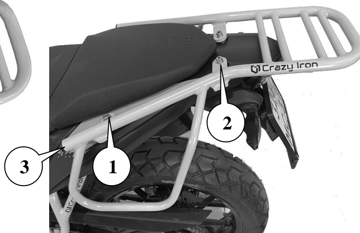
Рис 2 Вид слева на установленное крепление заднего кофра
