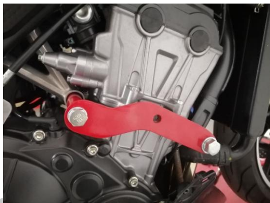
Рис.3. Установленная правый кронштейн
