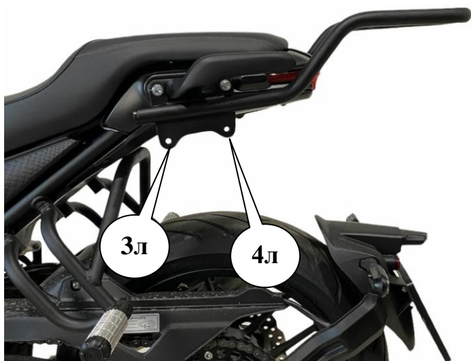
Рис 1 Вид слева на установленное крепление заднего кофра арт. 5030150
