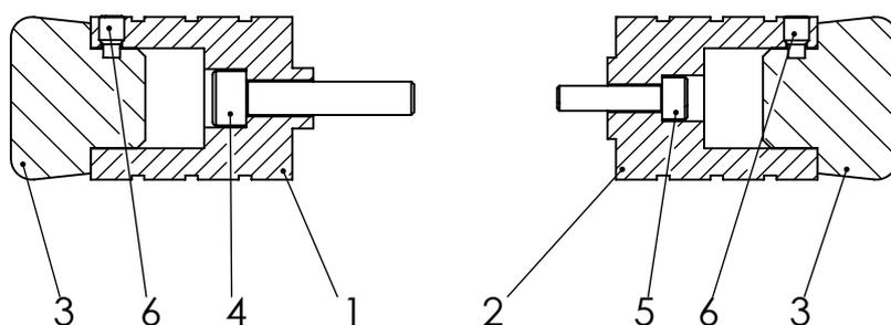
\*Для установки левого пегга необходимо в оси колеса с соответствующей стороны просверлить отверстие  $\varnothing 6.8\text{мм}$  под резьбу M8x1.25, а затем нарезать резьбу M8x1.25 на глубину 25 - 30мм.
