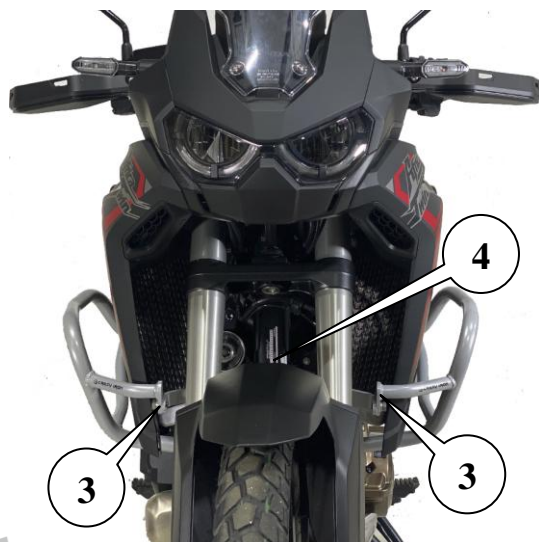
Рис 3 Установленные дуги, вид спереди
