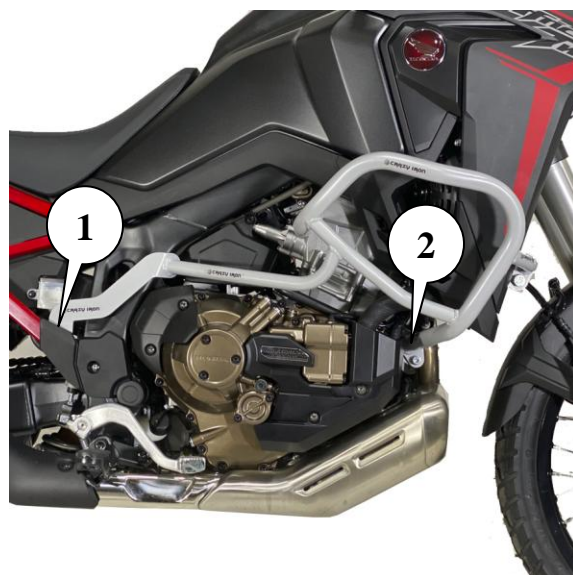
Рис 2 Установленные дуги, вид справа
