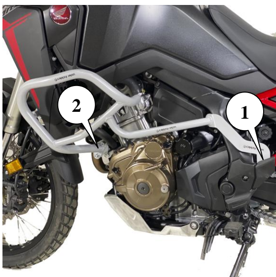
Рис 1 Установленные дуги, вид слева
