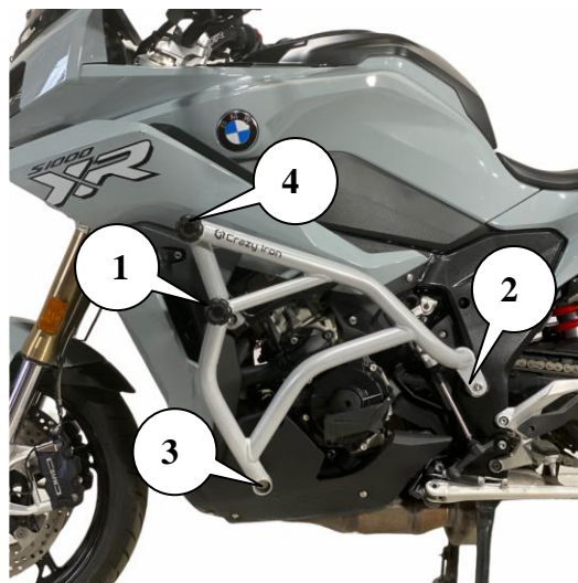
Рис.2. Установленная клетка вид слева
