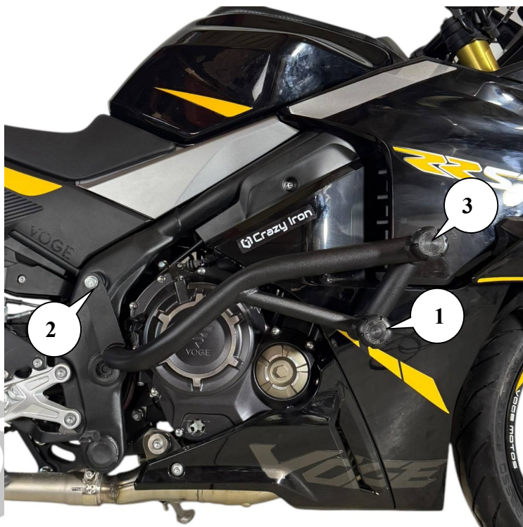
Рис 1 Установленная защита вид справа
