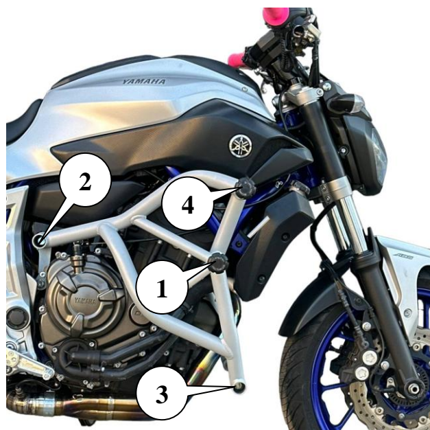
Рис.2. Установленная клетка вид справа
