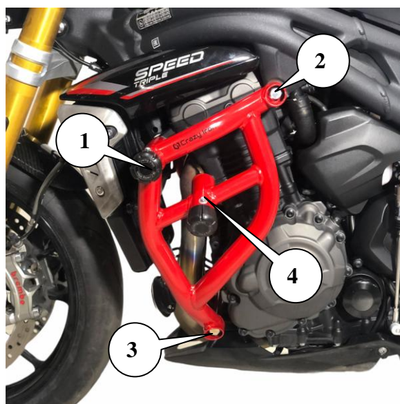
Рис.2. Установленная клетка вид слева
