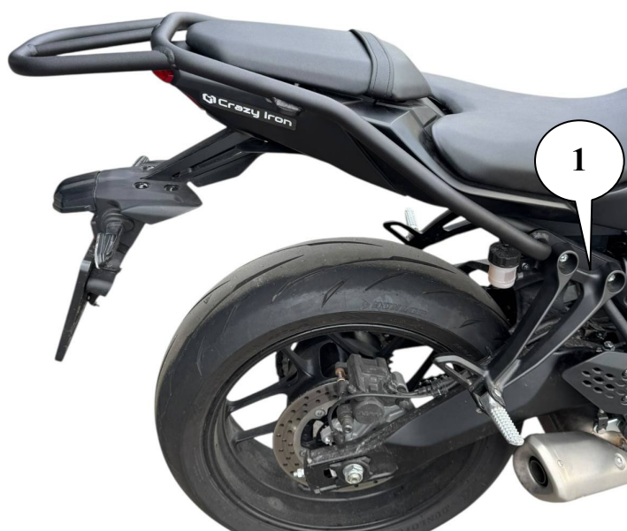
Рис 3 Общий вид установленного багажника
