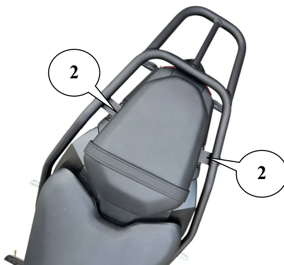
Рис 2 Общий вид установленного багажника
