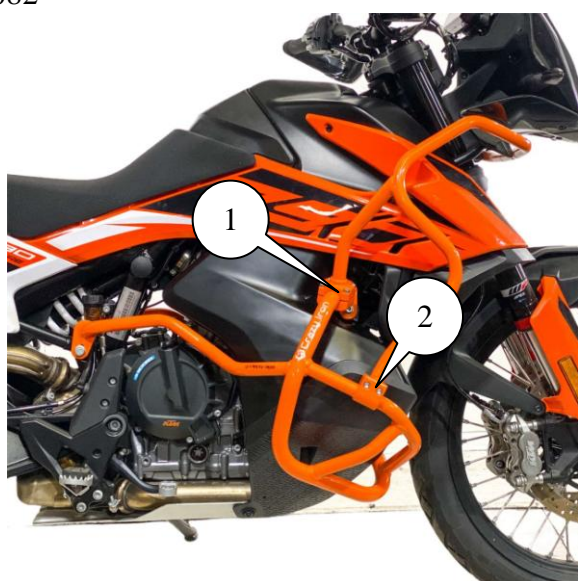
Рис.1. Установленная клетка вид справа
