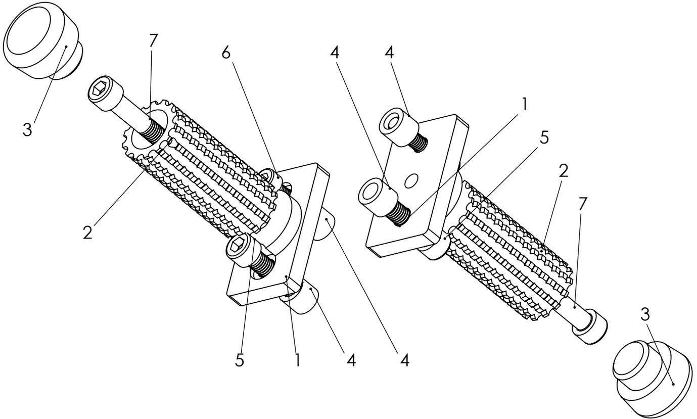
Обращаем Ваше внимание, что в комплекте присутствуют несколько типов болтов позиция 5, отличающиеся шагом резьбы (1.25 и 1.5), поэтому для крепления кронштейна пегов к маятнику используйте или болт M10x40x1.25 или M10x40x1.5 в зависимости от шага резьбы в мотоцикле (если при монтаже кронштейна, болт (позиция 5) не закручивается, не прикладывайте чрезмерное усилие, а замените на болт с другим шагом резьбы из комплекта).
