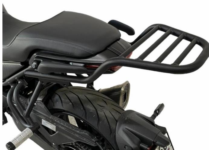
Рис 2 Общий вид сзади на установленное крепление заднего кофра
